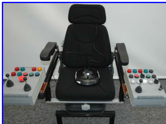
Rys.1. Widok stanowiska użytkownika narzędzia do interaktywnego odwzorowania zdarzeń wypadkowych
