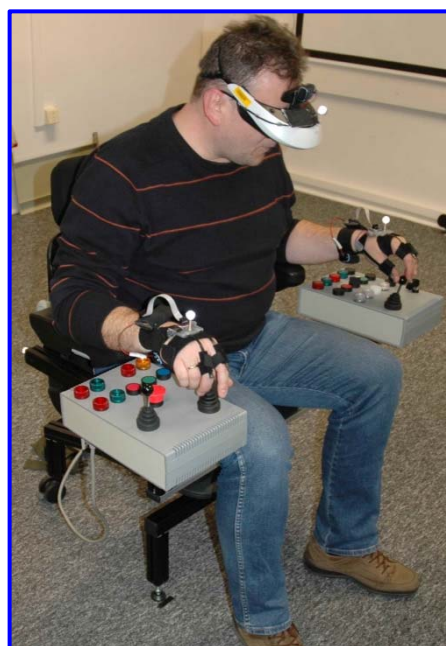
Rys.2. Sposób posługiwania się narzędziem za pomocą dwóch rzeczywistych paneli sterowniczych
