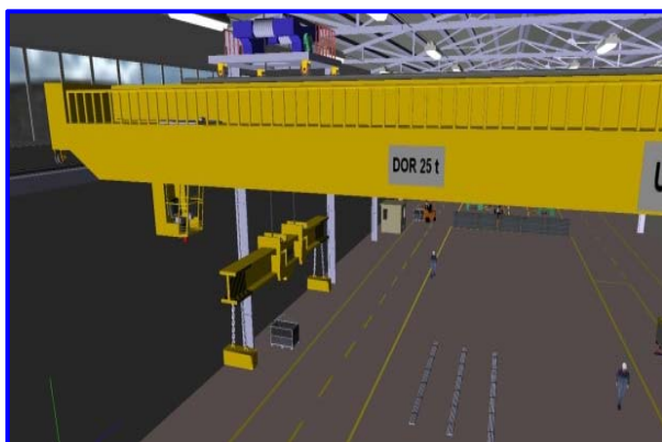
Rys.3. Widok fragmentu środowiska hali produkcyjno-magazynowej z suwnicą wyposażoną w trawersę z elektromagnesami
