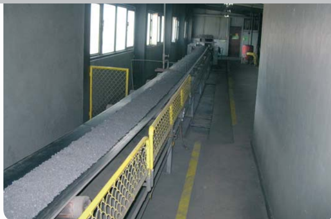
Fot. 2. Transport węgla przenośnikiem poziomym Fig. 2. Horizontal conveyor transporting coal
