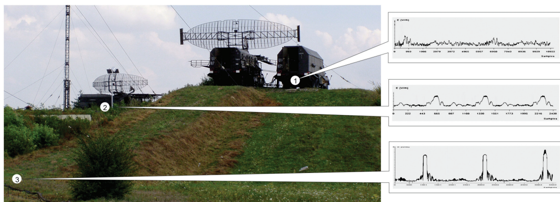
Rycina 7. Widok charakterystycznych miejsc przebywania pracowników w pobliżu obracającej się anteny (po lewej) oraz wartości natężenia pola elektrycznego w funkcji czasu w tych obszarach (po prawej). Wartości natężenia pola elektrycznego są przedstawione w czasie pomiaru wynoszącym 0,5 min
