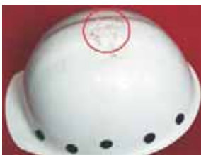
Fot. 5. Odpryski materiału skorupy o dużej powierzchni Photo 5. Defects in the surface of a shell
