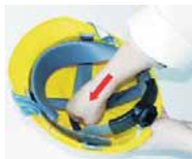
Fot. 7. Sprawdzanie więźby hełmu Photo 7. Inspection of a cradle
