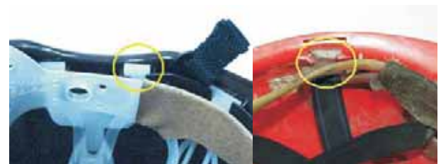
Fot. 8. Uszkodzenia gniazd zaczepów więźby Photo 8. Damage of the sockets of a cradle
