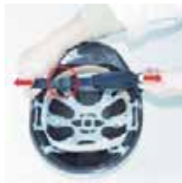
Fot. 13. Sprawdzanie paska podbródkowego Photo 13. Inspection of the chin strap
