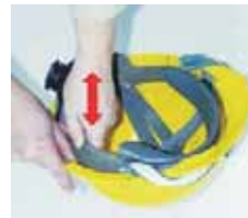
Fot. 11. Sprawdzanie połączenia pasa głównego ze skorupą hełmu Photo 11. Inspection of the connection between a headband and a shell
