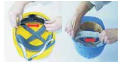
Fot. 12. Sprawdzanie trwałości ustawienia długości pasa głównego Photo 12. Inspection of the reliability of the adjuster of headband length
