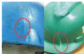
Fot. 2. Pęknięcia skorup hełmów Photo 2. Fractures of helmet shells
