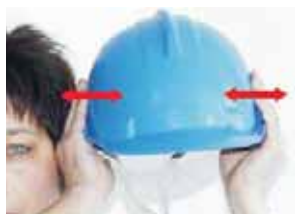
Fot. 1. Sprawdzenie trzeszczenia skorupy hełmu Photo 1. Inspection of cracking of a shell
