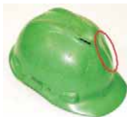
Fot. 3. Deformacja skorupy hełmu Photo 3. Deformation of a shell
