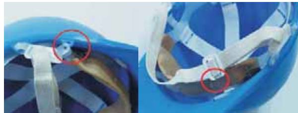
Fot. 14. Uszkodzenia elementów paska podbródkowego Photo 14. Damage of the elements of the chin strap
