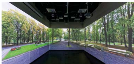
Rys. 5. Widok alei parkowej odwzorowanej w środowisku SEMI-CAVE dający złudzenie głębi
