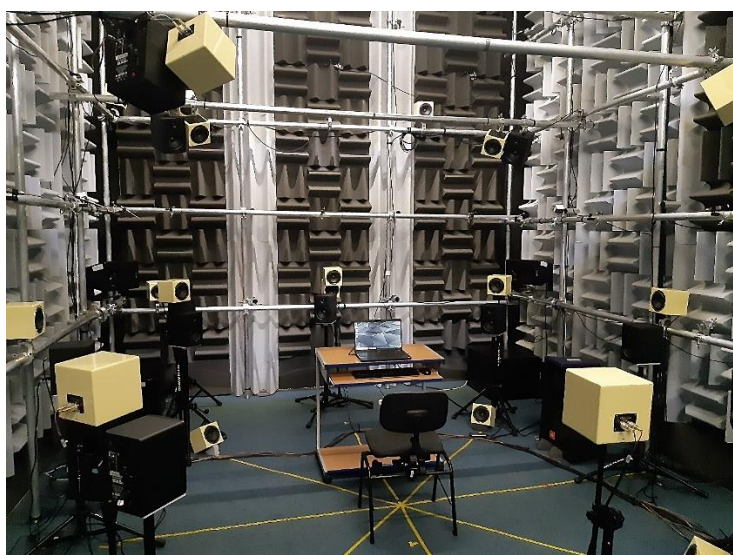
Zadanie 2.SP.02. Stanowisko do badań uciążliwości hałasu turbin wiatrowych
