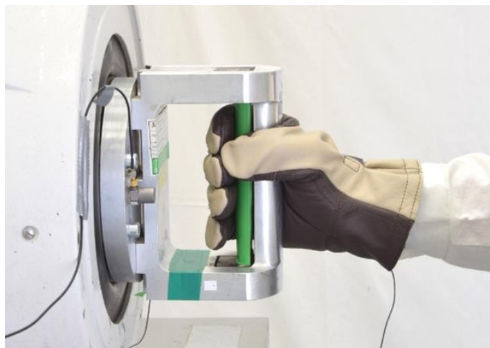
Zadanie 3.SP.05. Przykładowa rękawica antywibracyjna podczas badań na laboratoryjnym stanowisku pomiarowym
