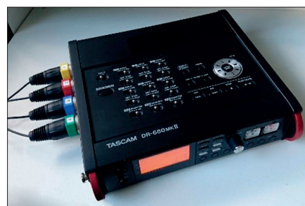
Fot. 3. Wielokanałowy rejestrator cyfrowy wykorzystywany do rejestracji sygnału z mikrofonu ambisonicznego
