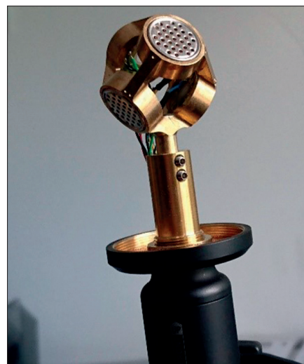
Fot. 2. Mikrofon ambisoniczny (na zdjęciu przedstawiono mikrofon ze zdjętą osłoną przeciwwietrzną)
