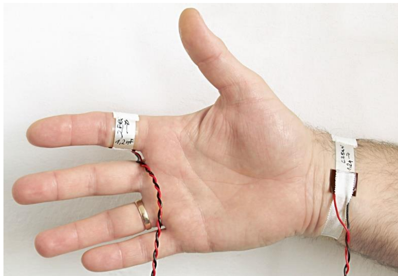
Projekt III.PB.20. Wstępne rozmieszczenie czujników (system przewodowy)
