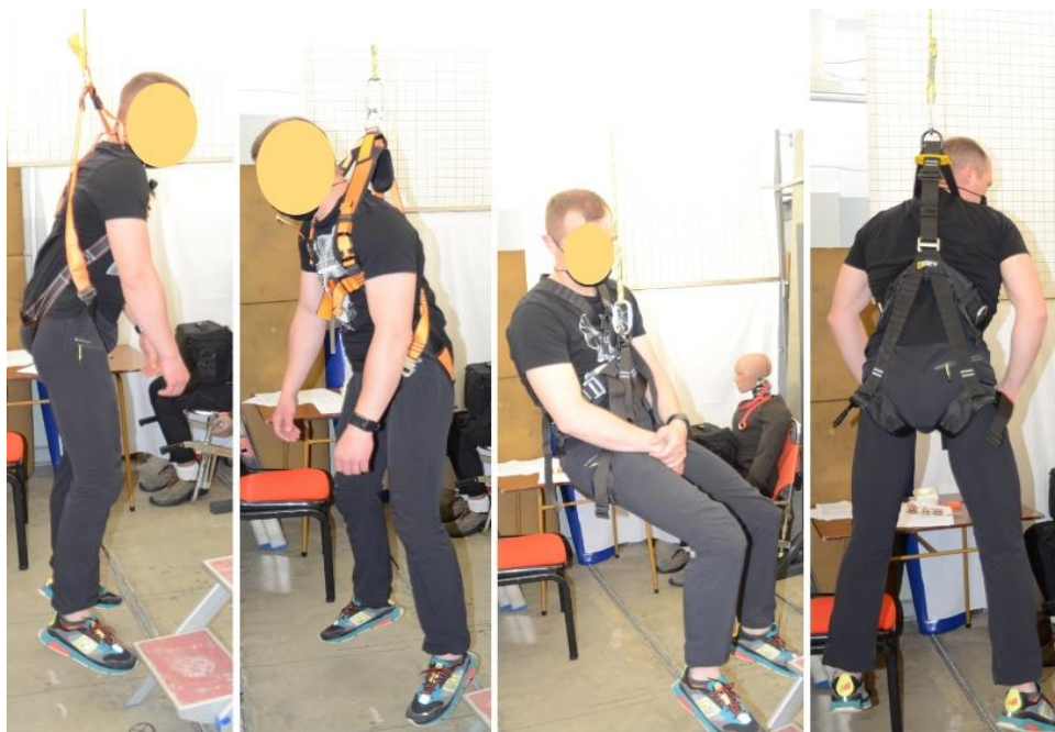
Projekt III.PB.16. Badania działania szelek bezpieczeństwa na ciało człowieka w stanie jego zawieszenia realizowane z udziałem ludzi
