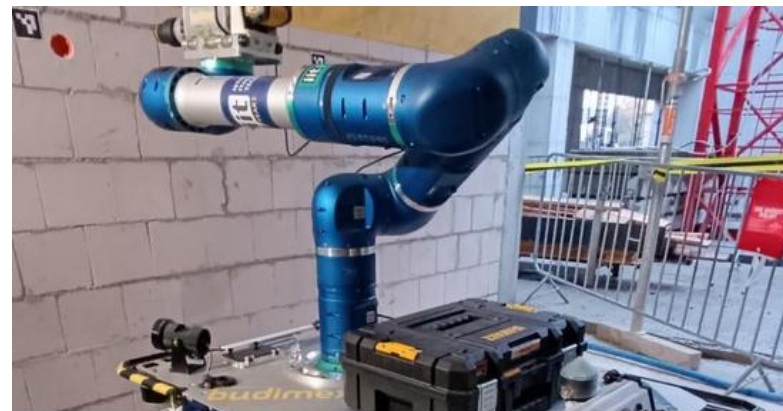
Budimex testuje robota współpracującego przy pracach na budowie
